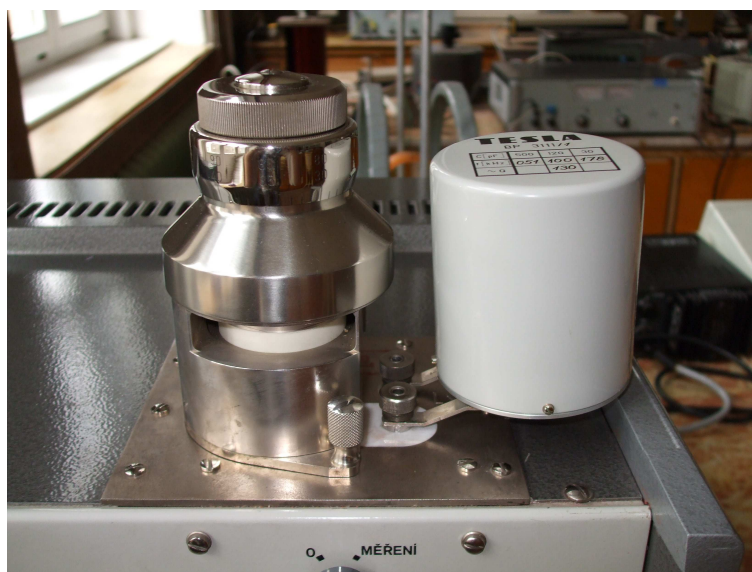
Obr. 10 – IV – Detail přípravku pro měření dielektrik
