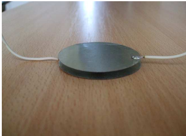
Obr. 25 – IV – Detail kondenzátoru pro měření dielektrické konstanty ledu
