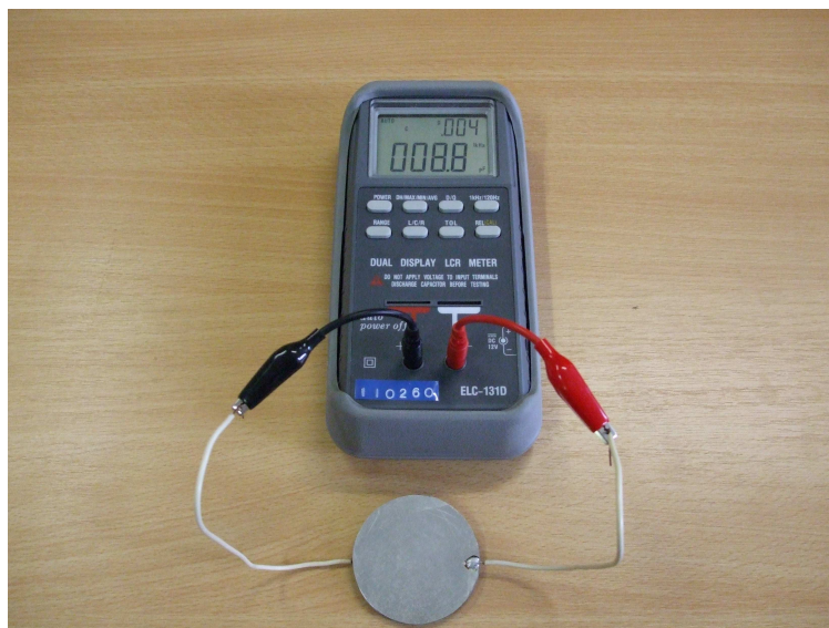
Obr. 26 – IV – Měření kapacity prázdného kondenzátoru
