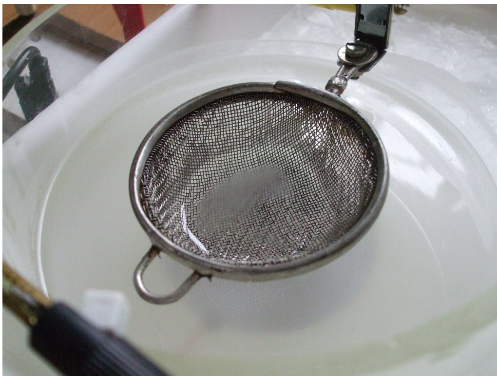
Obr. 21 – IV – Vznik druhého fázového rozhraní u hladiny kapalného parafínu
