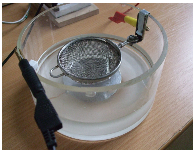
Obr. 19 – IV – Kapalný parafín v nádobě pro měření termodielektrického jevu
