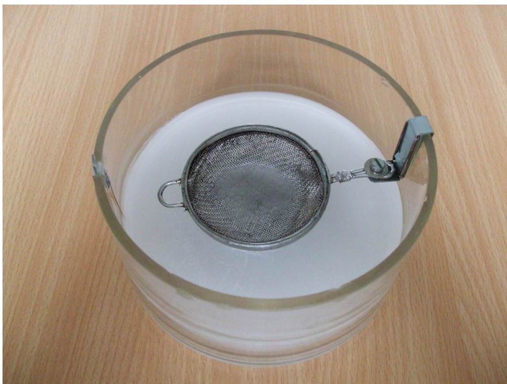
Obr. 22 – IV – Ztuhlý parafín po skončení měření termodielektrického jevu
