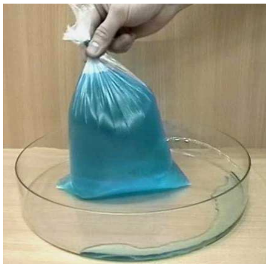
Obr. 18: Působení tlakové síly kapaliny na stěnu
