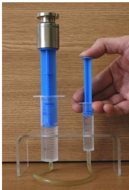
Obr. 65: Model hydraulického zařízení
