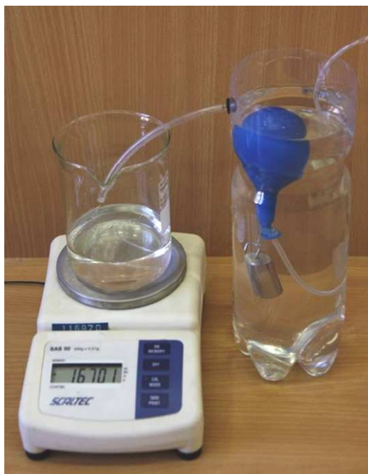
Obr. 55: Jednoduchý Archimédův výtah
