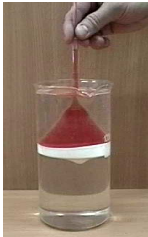
Obr. 22: Přístroj ukazující tlakovou sílu v kapalině
