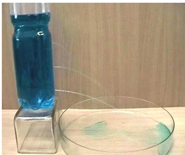
Obr. 23: Závislost velikosti hydrostatického tlaku na hloubce
