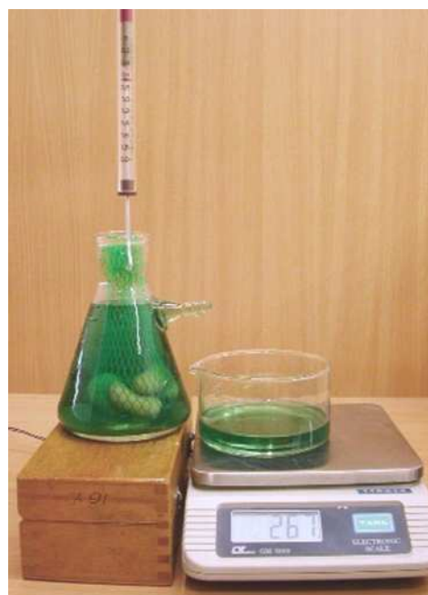
Obr. 32: Ověření Archimédova zákona pro tělesa nepravidelného tvaru
