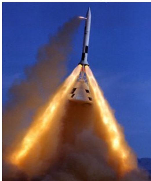
Obrázek 9.160: Únikový systém při testu, Zdroj: Wikipedie
