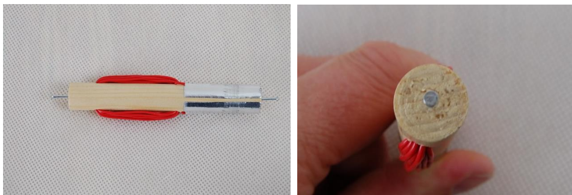
Obrázek 7: (a) Rotor stejnosměrného motoru: cívka – vodič s izolací namotaný na dřevěném válci, komutátor – dva obdélníkové kusy vodivé aluminiové fólie. (b) Detail osy rotoru – hlavičky hřebíku.
