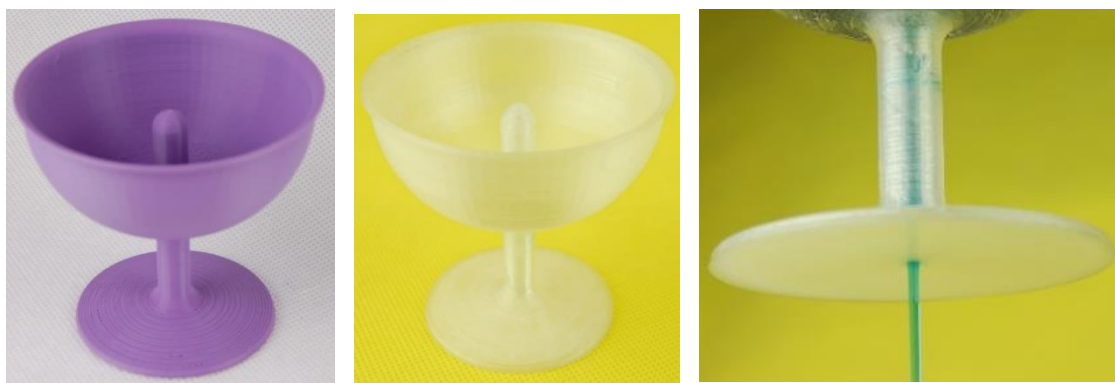
Obrázek 4: (a) Pohár vytisknutý barevným filamentem. (b) Tisk transparentním filamentem. (c) Voda vytékající z dolní části, transparentní materiál umožňující pozorovat cestu vody stopkou poháru.
