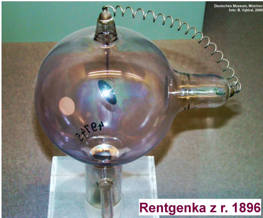
Obr. 13: Původní Röntgenova rentgenka (Deutsches Museum, Mnichov)
