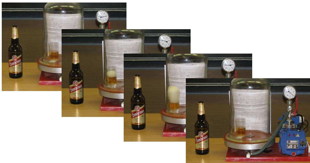
Obr. 4: Průběh pokusu s pivem ve vývěvě
