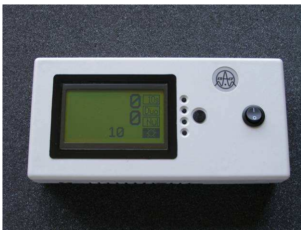
Obr.1: Čítač GM01 v režimu měření z obou vstupů po dobu 10 s
