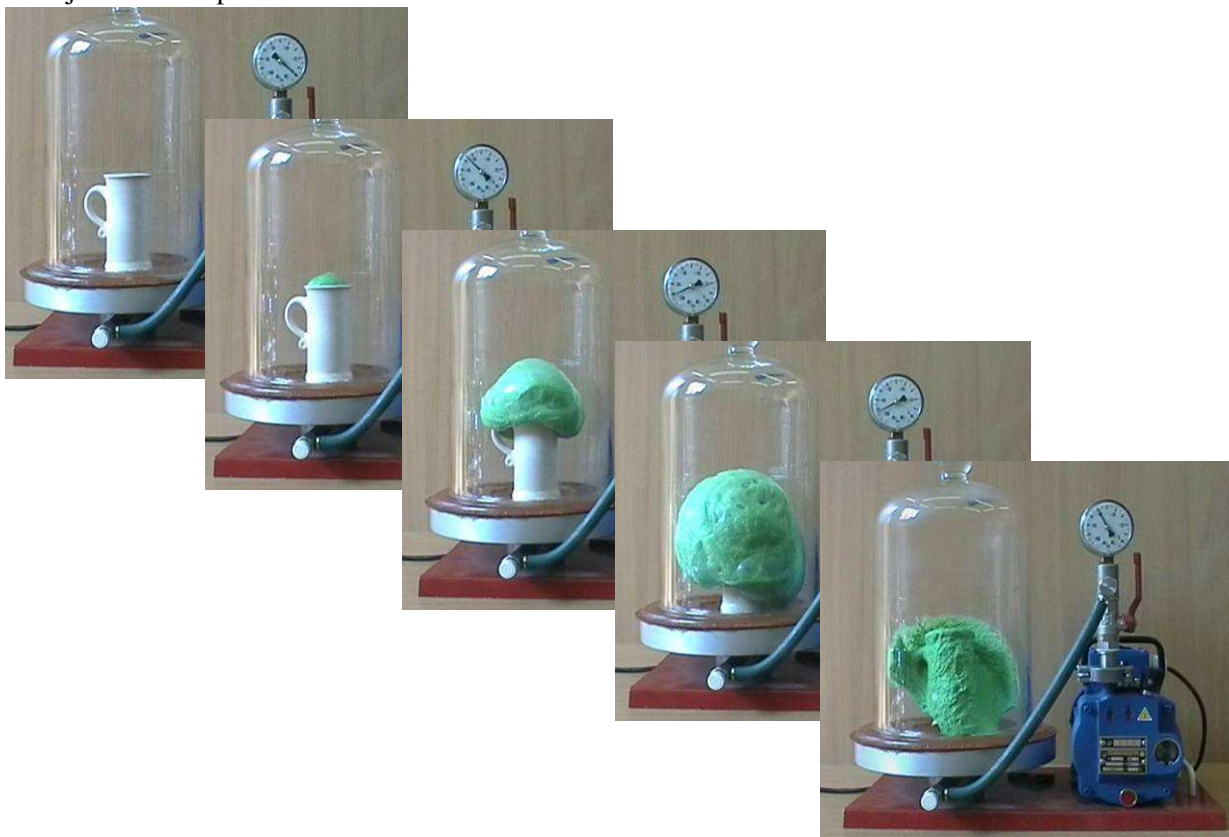
Obr. 2: Průběh pokusu se slizem ve vývěvě
