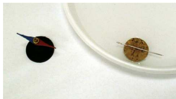
Obr. 12: Vyrobený kompas a kontrolní magnetka
