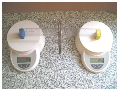
Demonstrace rozkladu síly na dvě rovnoběžné složky
