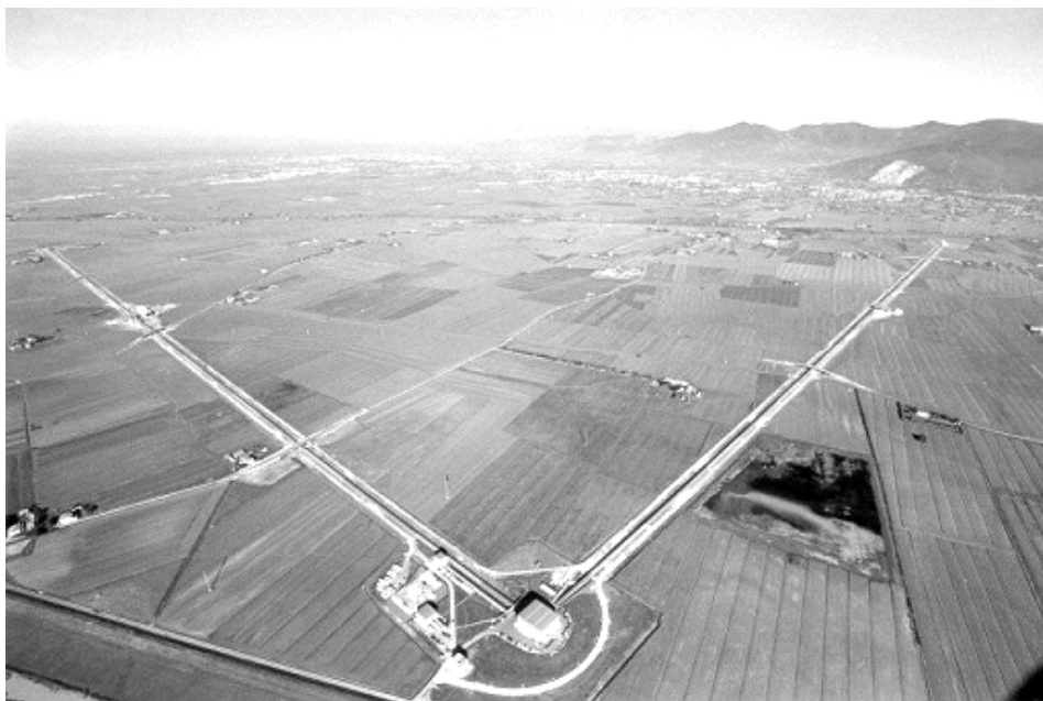
Obr. 3. Italský laserový interferometr VIRGO (Pisa, 2003), délka každého z ramen je 3 km
