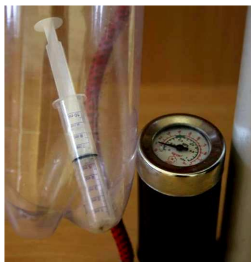
Obr. 68: Přetlak v láhvi s injekční stříkačkou
